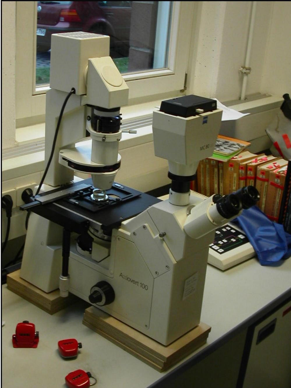
Das Utermöhl-Umkehrmikroskop mit einer 10 ml-Kammer auf dem Objektisch
