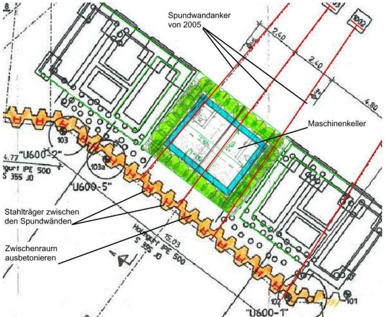
Bild 10: Gründung der Widerlagerbank, Grundriss
