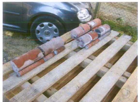
Bild 5 entnommene Bohrproben vor Transport
