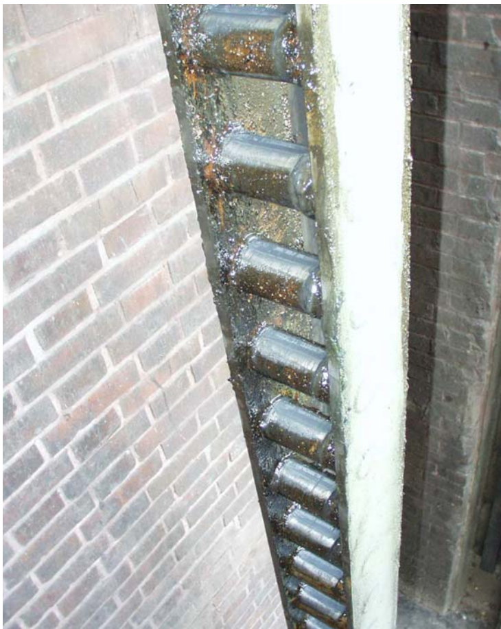
Bild 42 und 43: Triebstockleitern mit Abnutzungen
