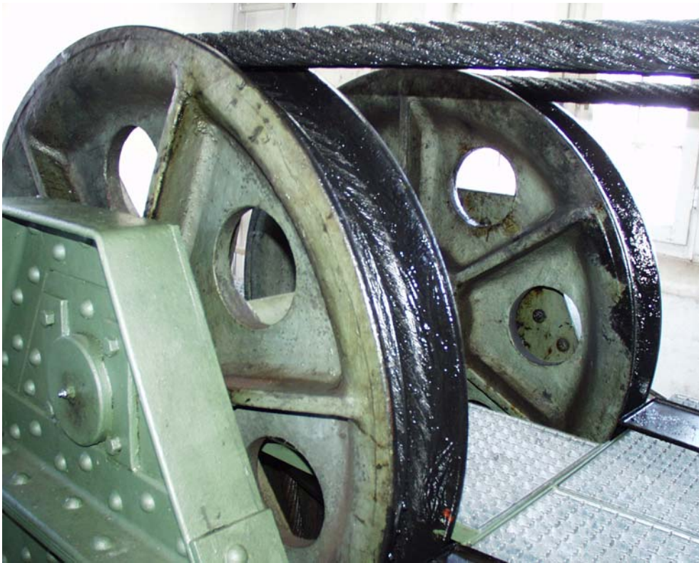
Bild 15 und 16: Seilscheiben der Gegengewichte in den Turmköpfen
