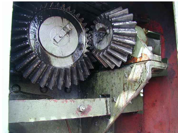
03 P6150576 Kegelräder am Getriebeturm 2.jpg
